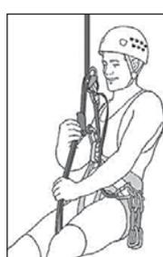
Схема работы с устройством REVERSO фирмы Petzl
