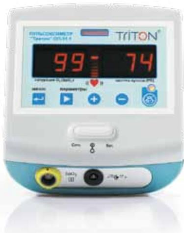
Предназначен для непрерывного длительного неинвазивного определения насыщения (сатурации) кислородом гемоглобина артериальной крови ( $SpO_2$ ) и частоты пульса (PR) методом двухволновой оптической оксиметрии.
