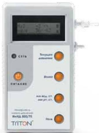
Уникальный портативный прибор, предназначенный для инвазивного однократного измерения или мониторинга центрального венозного давления и других низких давлений в различных полостях организма человека с высокой точностью.
