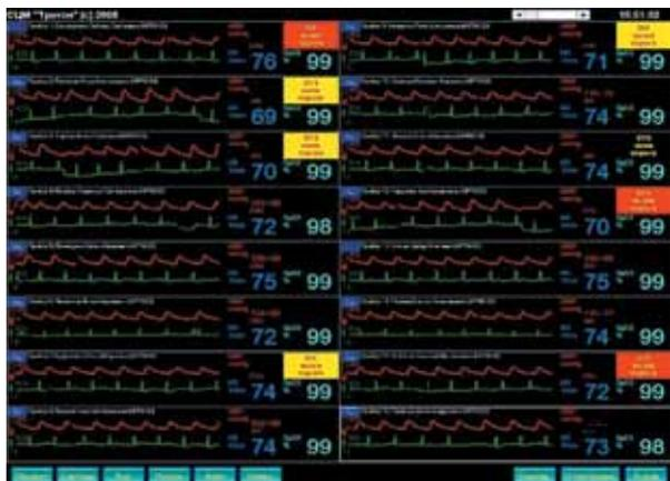
Система централизованного мониторинга позволяет объединить в общую сеть прикроватные мониторы с использованием проводных или беспроводных технологий передачи данных. Централизованный мониторинг значительно экономит время медицинского персонала и повышает уровень безопасности пациентов.
